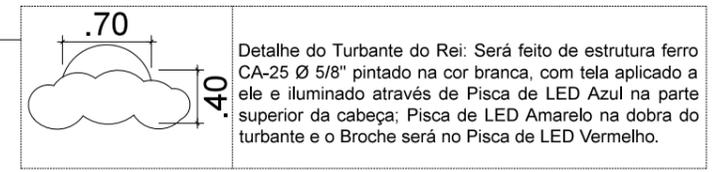
Detalhe do Turbante do Rei: Será feito de estrutura ferro CA-25 Ø 5/8" pintado na cor branca, com tela aplicado a ele e iluminado através de Pisca de LED Azul na parte superior da cabeça; Pisca de LED Amarelo na dobra do turbante e o Broche será no Pisca de LED Vermelho.
