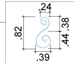
Detalhe do elemento arabesco com formato feito em barra chata 3/4" x 1/4" pintado na cor branca e Mangueira de LED fixado a ele com abraçadeira plástica, com dimensões de 80 cm de altura e 30cm de largura.
