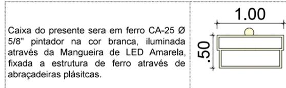
Caixa do presente sera em ferro CA-25 Ø 5/8" pintado na cor branca, iluminada através da Mangueira de LED Amarela, fixada a estrutura de ferro através de abraçadeiras plásticas.
