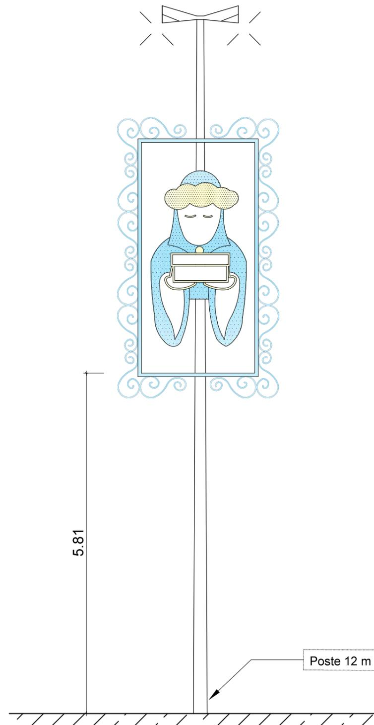
Portal do Quadro de Baltazar em estrutura tubo de aço Ø 15.0 mm, com dimensão de 2.00 m de largura por 4.00 m de altura, com iluminação somente no contorno através de uma Mangueira de LED Azul fixado a estrutura com abraçadeiras plásticas.
