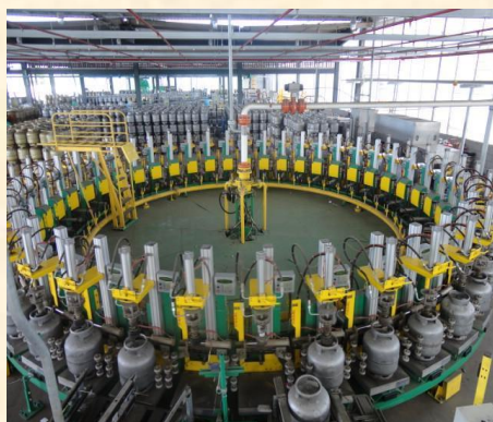
Figura 16 – Carrossel Eletrônico para enchimento de botijões de GLP.
