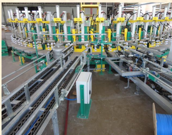
Figura 18 – Entrada (direita) e saídas (esquerda) do Carrossel Eletrônico.
