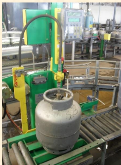
Figura 21 – Balança de mais ou menos (ajuste de peso).
